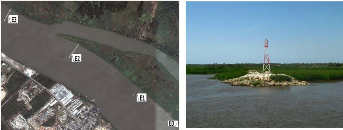
**Obras de profundización del canal de acceso al Puerto de Barranquilla:** El objetivo del proyecto consiste en garantizar un canal de 40 pies de profundidad entre la desembocadura del río en Bocas de Ceniza y los Terminales Portuarios de Barranquilla, la terminación de la obra se tiene previsto para febrero de 2009. Se construyeron los espolones E0, E1, E2, E3 de la Isla 72. Se continúa con la construcción del E6 y el dique guía.
