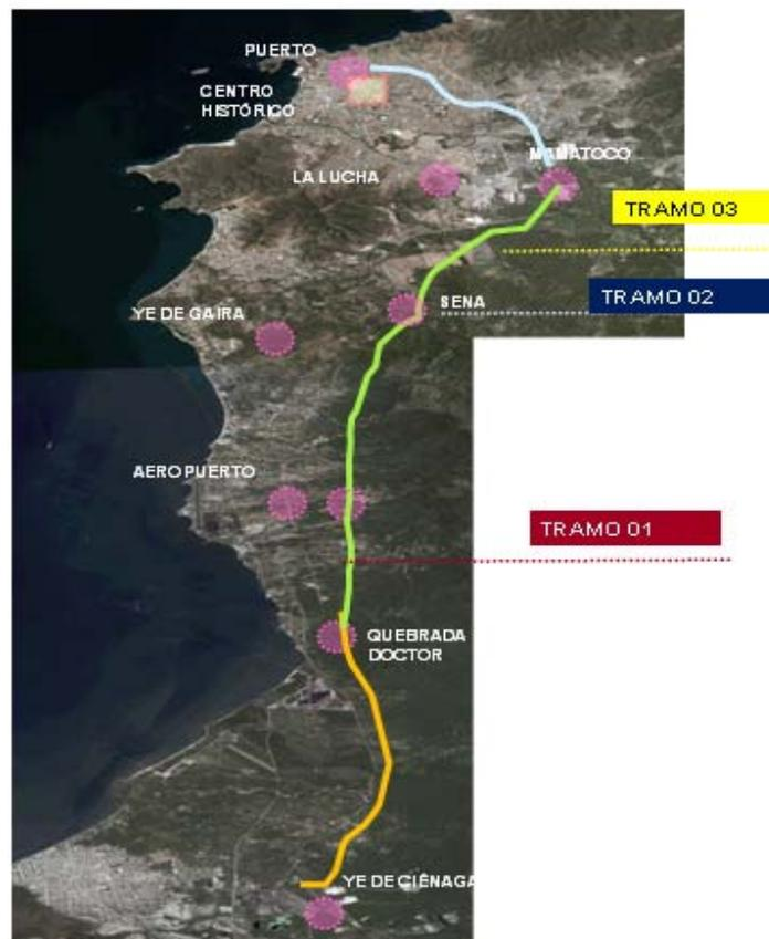
**Tramo 1:** Entre el área adyacente a la quebrada El Doctor y el PR 4+400 (Quebrada el Limón) se hizo el desmonte y descapote del K0+000 al K1+000. Se Construyeron alcantarillas cajón en el K0+600 y en el K0+900.
