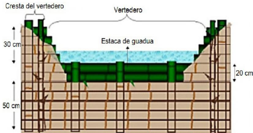
Figura 840 - 5. Detalle construcción vertedero con Trinchos Vivos. Rivera Posada, José Horacio (2002) Avances técnicos CENICAFÉ 296.
