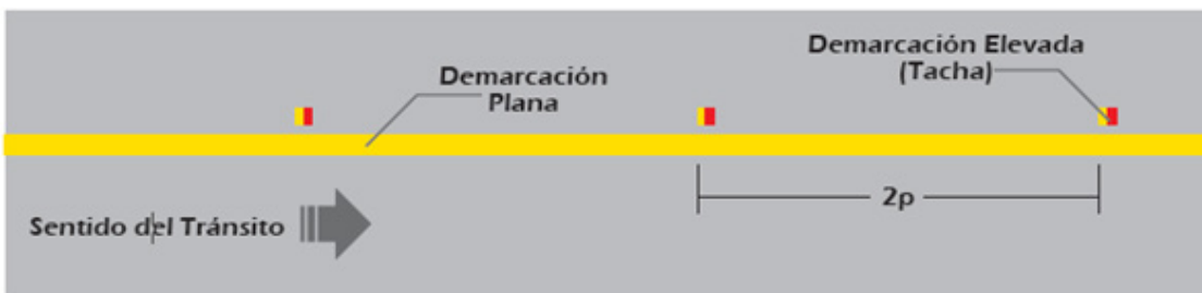
Figura 703-19 Separación con línea amarilla entre carril y berma izquierda con una separación entre tachas = 2p , según patrón de la Tabla 703-3.
