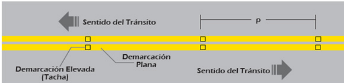
Figura 703-8 Separación vía doble sentido con restricción de adelantamiento en ambos sentidos con una separación entre tachas=1/2p según patrón de la Tabla 703-3.
