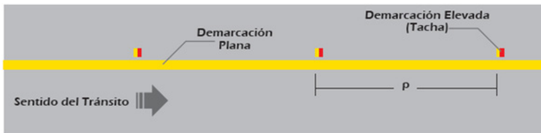
Figura 703-19 Separación con línea amarilla entre carril y berma izquierda con una separación entre tachas = 2p , según patrón de la Tabla 703-3.
