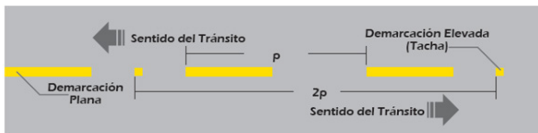
Figura 703-3 Separación vía doble sentido y 2 carriles sin restricción de adelantamiento con un patrón de demarcaciones segmentadas en la vía= p y una separación normal entre tachas= 2p .
